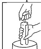
Enlever la tête de la pompe. Plonger le corps de la pompe de 3 cm environ dans la graisse. Aspirer la graisse à l'aide de la tige de remplissage. Revisser la tête de la pompe. Débloquent la tige de remplissage
