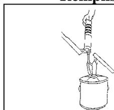
Purger d'abord l'appareil de remplissage. Ne pas forcer en fin de remplissage. Mettre le levier de la pompe en position ouverte avant le remplissage.
