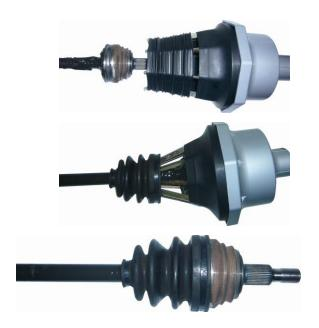
Mettre l'expandeur de soufflet sur le joint homocinétique et presser le bouton ("\_").
