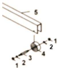
Fixer les 2 roues arrières à la base à l'aide des rondelles et vis (7-13-14-15)
