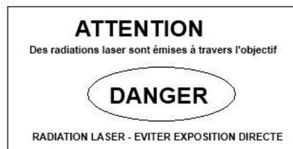
Limite d'émissions : 1mW (longueur d'onde 663 nm)
