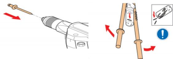
Le choix du nez de pose approprié est indispensable au bon fonctionnement de l'appareil. Lorsqu'elle sort de notre atelier de production, la pince est équipée d'un nez de pose, d'autres nez de pose sont vissés sur l'un des bras de la pince. Les nez de pose se changent par simple vissage ou dévissage.
