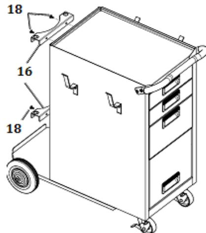
Fixer les casiers à bouteilles (16) à l'arrière du boîtier à l'aide de 2 vis.
