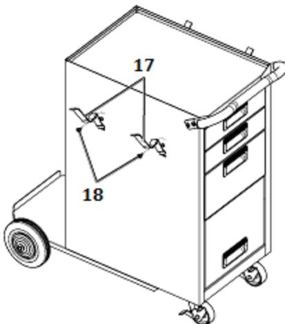
Insérer l'extrémité inférieure de l'un des supports de bobine (17) dans l'une des fentes sur le côté de la servante et le fixer avec une vis (18). Répéter l'opération pour les 4 supports de bobines.
