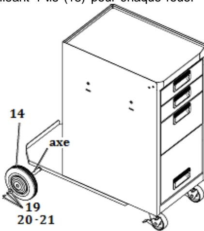
Placer les roues (14) sur les essieux à l'arrière du panneau (15). Fixer les roues sur les essieux en utilisant les rondelles (19), (20) et les boulons (21).
