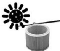
Nettoyer de temps en temps le filtre avec une brosse souple et de l'eau, ou laver le à l'eau propre et chaude. Laisser sécher pour que la poussière n'adhère pas sur le filtre humide.
