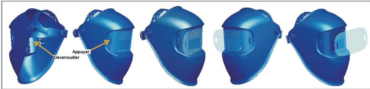
Remettre l'écran neuf en s'assurant qu'il soit maintenu correctement par les deux ergots.
