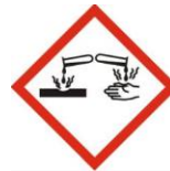
Contient produit corrosif (batterie)
