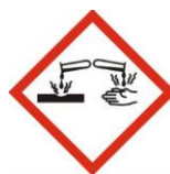
Zawiera substancje żrące (akumulator)
