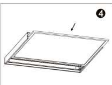
4. Mettre la dalle LED à l'intérieur du cadre
