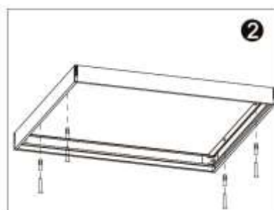
2. Fixer le cadre au plafond avec des vis et chevilles
