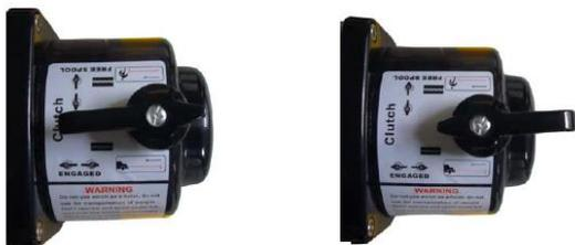
Pour débrayer, déplacer le commutateur sur la position "DEBRAYEE" (bobinage libre FREE SPOOL)). Le câble peut être enroulé librement autour du tambour.
