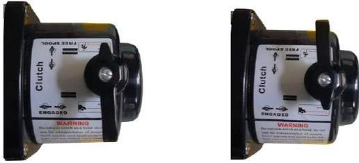
Pour embrayer, déplacer le commutateur sur la position "EMBRAYEE"(ENGAGED). Le treuil est maintenant prêt à être utilisé.
