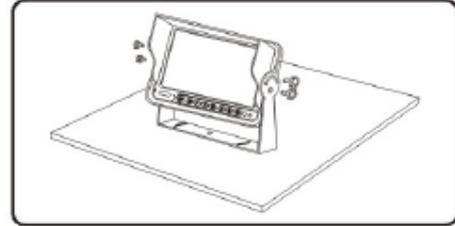
Installer le moniteur sur le support en U à l'aide des vis de serrage inférieures, ajuster l'angle puis placer les vis de serrages supérieures. Vous pouvez ajuster l'angle jusqu'à 30° vers l'avant et vers l'arrière.
