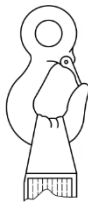
NOTE: Le rayon de boucle n'est pas montré pour la clarté de l'illustration. Figure D.1 — Illustration montrant l'installation inadéquate d'une boucle d'élingue sur un crochet de trop petit rayon
