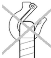
Le linguet de sécurité doit être fermé
