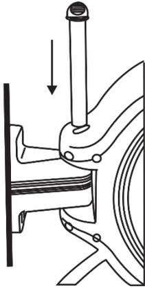
Aligner le dévidoir avec les trous verticaux du support et insérer le tube pivot
