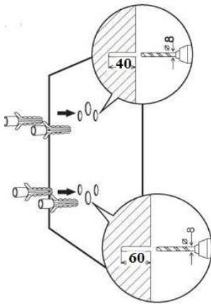
Percer le mur à l'aide d'une perceuse électrique, à une profondeur d'environ 60 mm.
