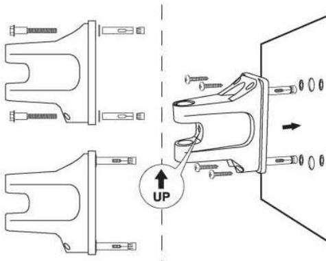
Utiliser les éléments de fixations fournis, mettre en place les chevilles et visser le support fermement.
