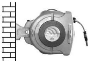
Le dévidoir doit pouvoir se fixer sur un mur et pivoter sur un arc de 180°. Prévoir 80cm d'espace de deux côtés du support mural.
