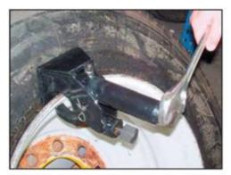
Tourner la partie (B) du talon dans le sens des aiguilles d'une montre pour commencer à déloger le pneu
