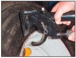
Pour commencer , positionner le talon au même niveau que le crochet en tournant la partie B
