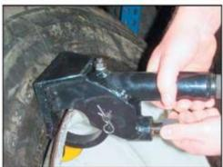
Serrer l'outil sur la jante en vissant manuellement le boulon (A).
