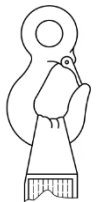
NOTE Le rayon de boucle n'est pas montré pour la clarté de l'illustration. Figure D.1 — Illustration montrant l'installation inadéquate d'une sangle d'élingue sur un crochet de trop petit rayon
